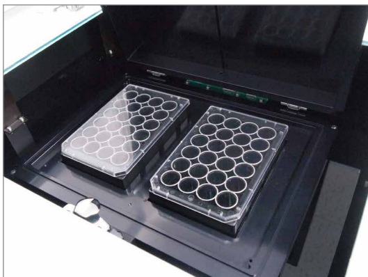
2개의 24-well plate 장착 가능한 샘플 스테이지
